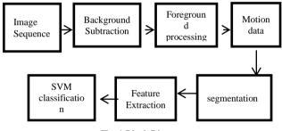
Fig. 1 Block Diagram
